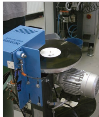
Und fertig ist die schwarze Scheibe! Die Pressmaschinen stammen übrigens nicht aus den 60-er Jahren, sondern wurden neu gebaut.
